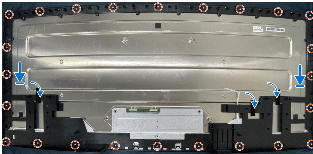
Obrázek 20. Instalace středového rámu
