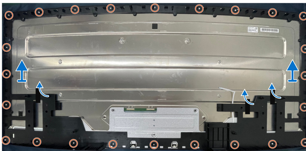
Obrázek 19. Demontáž středového rámečku
